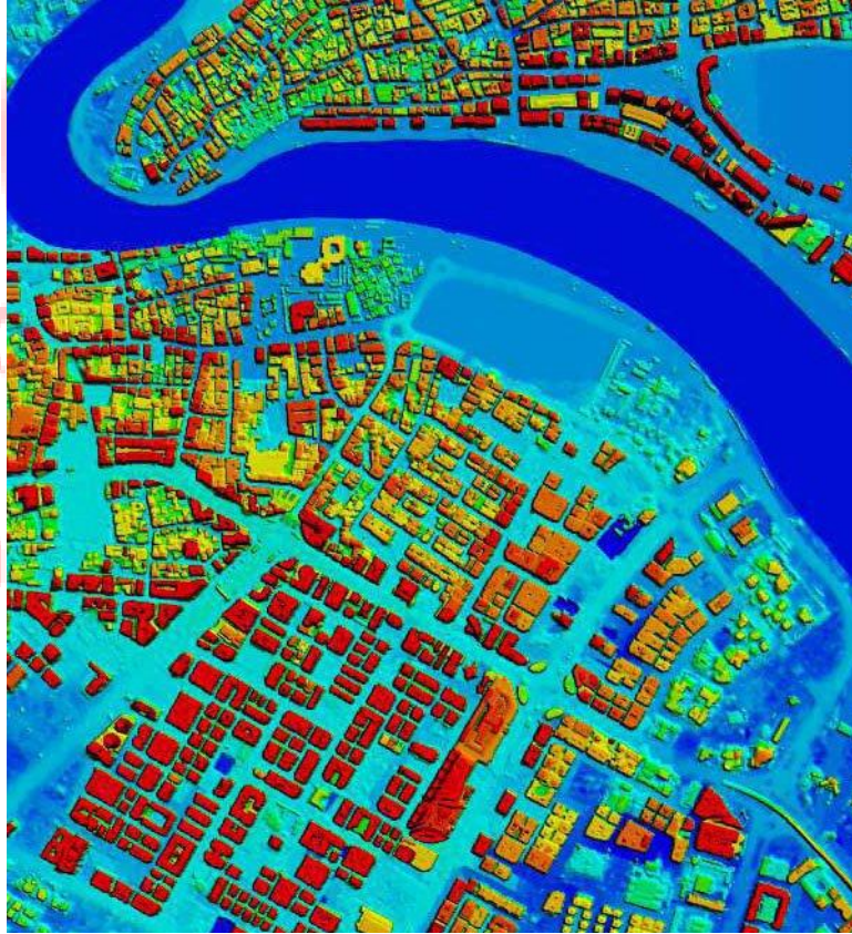
Şekil 38. Pleiades 1A uydu görüntüsünden üretilmiş sayısal yükseklik modeli [26].
