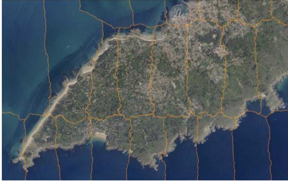
Şekil 2 Faydalı alan çizgileri (seamline) ile mozaiklenmiş ortogörüntü
